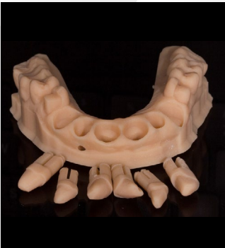
Fig. 11: Modelo impresso em 3D com matrizes em Primeprint Model
