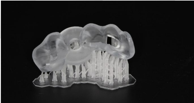
Fig. 7: Guia impressa em 3d com suportes feita em Primeprint Guide
