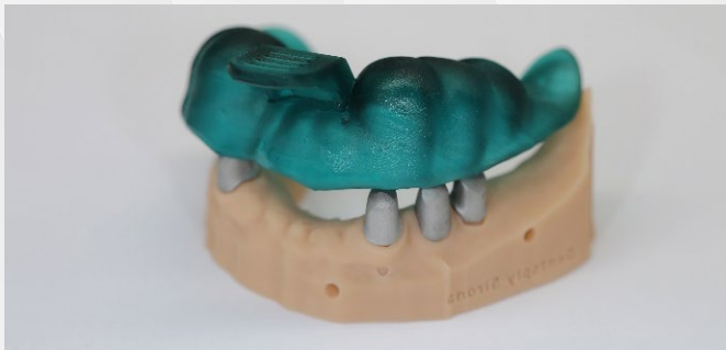
Fig. 10: Resultado da impressão: moldeira de impressão personalizada após apenas 30 minutos de impressão. O pós-processamento foi completado após mais 45 minutos
