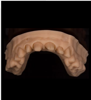
Fig. 11: Modelo impresso em 3D com matrizes em Primeprint Model
