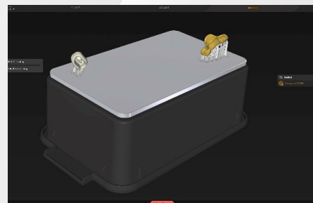
Fig. 15: Preparação do trabalho de impressão da ferramenta de inserção e uma coroa provisória (cópia da coroa final da Fig. 13) no inLab CAM 22
