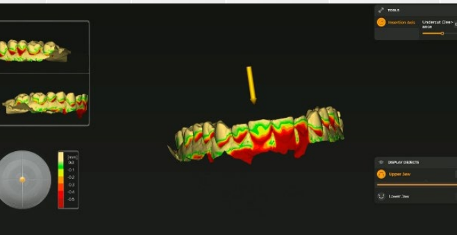
Fig 5: inLab SW, módulo “Splint” O software auxilia o design e dá opções para otimizar o encaixe
